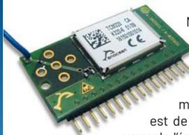
Nous travaillons sur le développement d'objets communicants grâce au module programmable TCM320 EnOcean avec antenne pré-installée. La technologie EnOcean permet une transmission radio d'informations (868 MHz) issue d'objets communicants, une autre particularité de cette technologie est de pouvoir fonctionner sans batterie en utilisant par exemple l'énergie produite par la pression mécanique exercée sur un interrupteur équipé d'un dispositif piézo-électrique.
